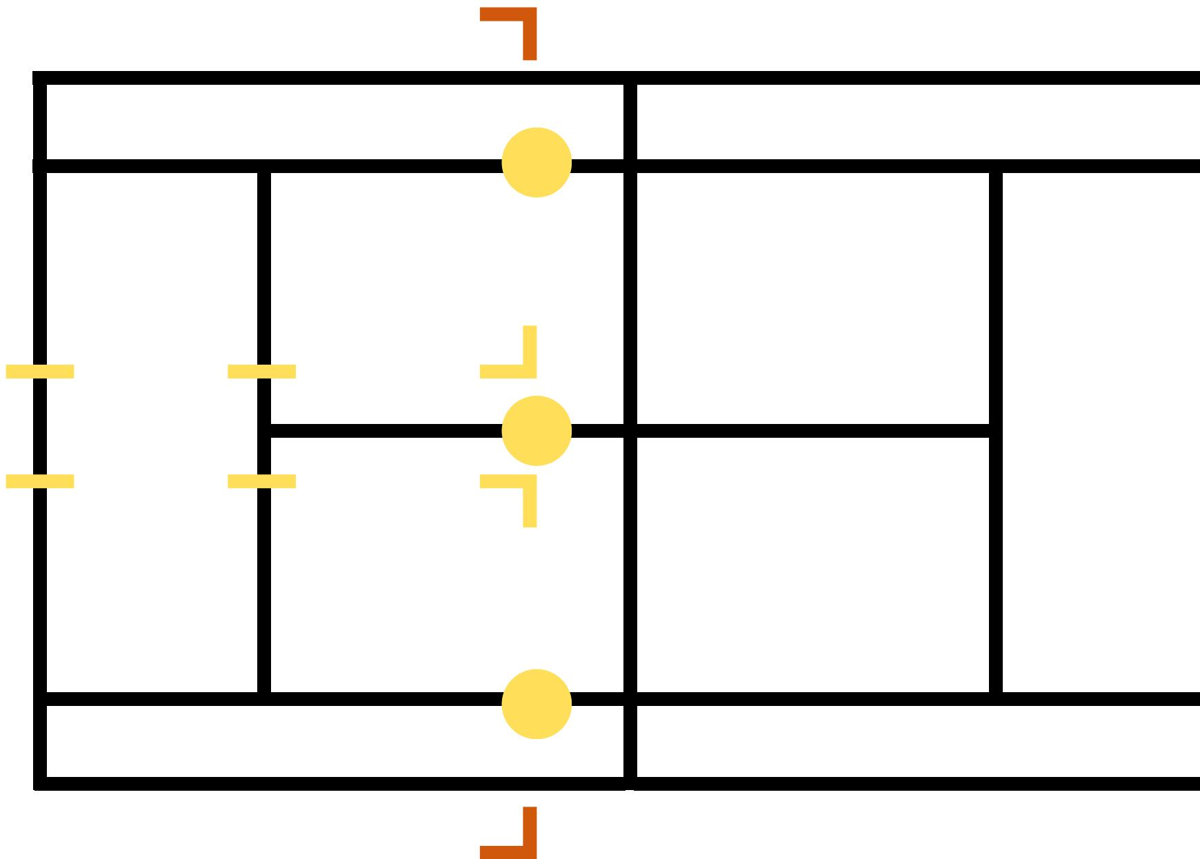
Passez au traçage des angles restants du fond de court, côté filet. Ces angles doivent être situés à 6,10 m (lignes comprises) du coin déjà mesuré.
